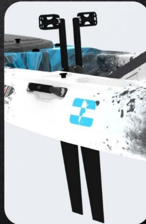
El sistema de pedales, se coloca y se quita en cuestión de segundos, basta con apoyar el eje de la pedalera sobre los soportes fijos al kayak y hacer presión hacia abajo hasta que trabaje. Para retirarla se empujan simultáneamente los pestillos con resorte hacia adelante con una mano, y con la otra se retira la pedalera hacia arriba
